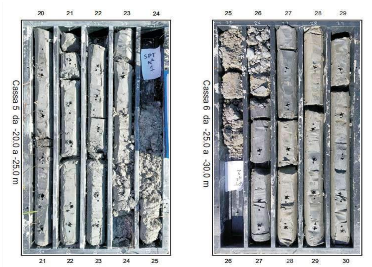
Figura 15c: foto campioni da -20,0 m a -30,0 m - SONDAGGIO 1
