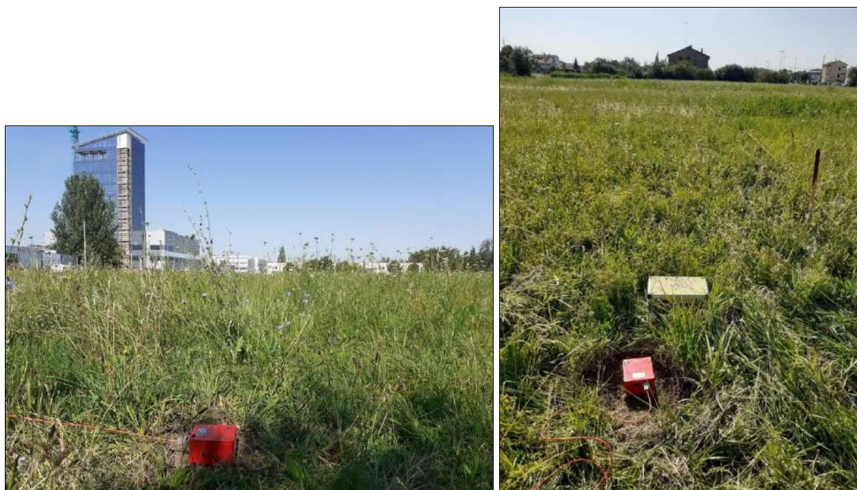
Figura 8: immagini della prova geofisica HVSr 1 e HVSr 2
