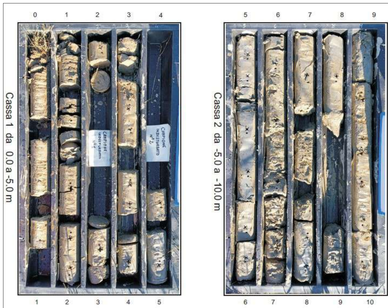
Figura 15a: foto campioni da 0,0 m a -10,0 m - SONDAGGIO 1
