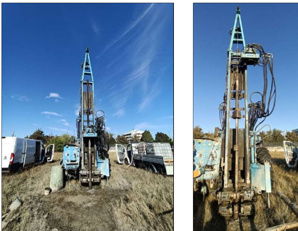
Figura 9a-b: immagini del sondaggio a carotaggio continuo e di una prova SPT
